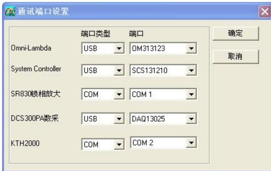
可根据各个仪器的连接方式和端口数据自行选择相应的数据进行设置。设置完成后点击“确定”按钮保存设置数据并退出界面；点击“取消”按钮直接退出界面且不对之前更改过的数据进行保存。
